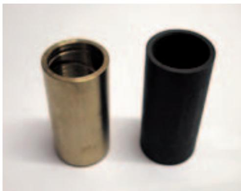
Ces bagues sont réalisées d'origine en bronze phosphoreux, dont la particularité est d'avoir un faible coefficient de frottement contre l'acier.
