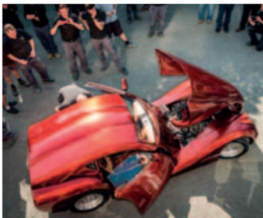
aluminium dérivé de l'Aéro et 4 petits moteurs électriques. La suspension et la structure étaient complètement nouvelles, avec une empreinte au sol réduite et très étroite, et l'accès au cockpit par des portes "papillon", s'ouvrant en hauteur.
